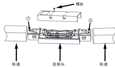
在拼接前先逆时针旋转1、2号螺丝使其部件松动，拼接后再拧紧1、2号螺丝。
