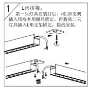
2 L形拼接: 将连接头过线的两边易撬孔徒手掰 开,再将电源线置于连接头内用螺丝 固定好,且连接头固定在灯具上.
