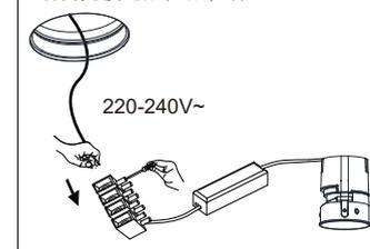
2.6 整理好电源线, 将驱动从开孔处置入天花板上, 然后将灯具卡入天花孔内.
