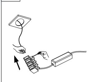
**3.3** ①拔出模组(侧斜先拔出一边卡扣后再拔出另一边卡扣).
