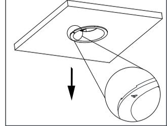
**4.2** ①拔出前环(侧斜先拔出一边卡扣后再拔出另一边卡扣).
