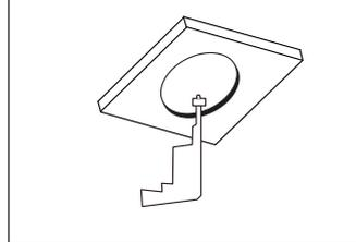
2.2 用4个自攻墙板钉均布的将预埋件固定在天花板开孔上.
