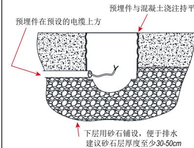
**1.2** 选用防水配件连接电源线, 灯体向下安装于预埋件内.
