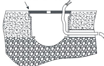
**2.2** 选用防水配件连接电源线，灯体向下安装于预埋件内。
