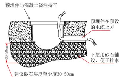
**1.2** 选用防水配件连接电源线, 灯体向下安装于预埋件内.
